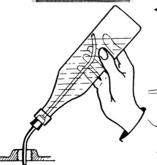
◄ Fig. 4: Pour rajouter de l'eau distillée, on peut utiliser ce remplisseur de batterie, qui se met en lieu et place du bouchon dans la bouteille contenant l'eau distillée. On versera l'eau en posant l'extrémité du remplisseur sur les éléments de la batterie. Si l'on procède de cette façon, l'eau distillée cessera de couler dès que le niveau nécessaire sera atteint.
