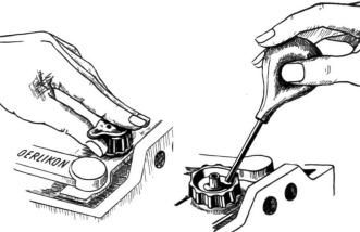
▲ Fig. 5: Les bouchons de remplissage spéciaux de la Fabrique d'accumulateurs d'Oerlikon sont conçus d'après le même principe.
