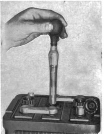
▼ Fig. 3: En mesurant le densité de l'acide, il faut veiller à ce que l'aréomètre flotte librement et ne touche pas la poire en caoutchouc, que la poire ne soit pas serrée pendant la lecture, et enfin que l'air soit aspiré lentement quand il y a déjà du liquide dans l'appareil.
