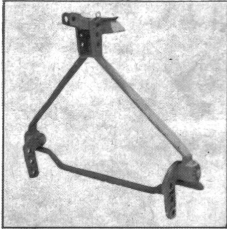
Fig. 3: Partie du système d'accouplement rapide PZ adaptée à la machine de travail.
