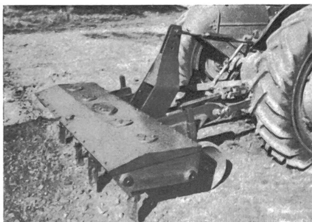
Fig. 4: La herse «Roter» à prise de force — Ce matériel permet d'effectuer diverses opérations. Il suffit de modifier son inclinaison pour qu'elle travaille de façon différente.
