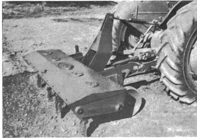
Fig. 4: La herse «Rotter» à prise de force — Ce matériel permet d'effectuer diverses opérations. Il suffit de modifier son inclinaison pour qu'elle travaille de façon différente.
