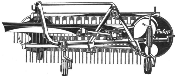
Le râteau faneur et andaineur «Polyp» est une machine de fenaision de haute qualité, éprouvée, aux aptitudes multiples. Ses peignes soulèvent délicatement le fourrage, le défont parfaitement et le retournent correctement. Les tiges ne s'enroulent pas autour des pièces travaillantes et il ne se forme pas de tresses. Les folioles, si précieuses par leur richesse en albumines, ne se détachent pas au cours des opérations d'épandage et de retournement.
