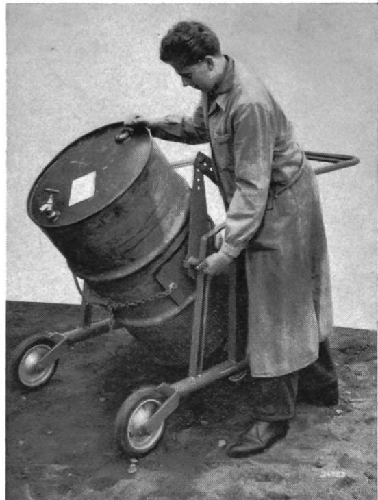
Quand on veut vider un fût plein, il faut tirer la cheville d'arrêt vers l'extérieur et faire pencher légèrement le fût (fig. 2). Lorsqu'il est en position horizontale, la cheville d'arrêt se rengage d'elle-même dans le trou correspondant et l'on peut à ce moment-là soutirer le liquide ou bien
