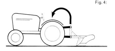
Tracteur équipé d'un relevage hydraulique à régulateur automatique de la profondeur de travail — lci la charrue est entièrement portée et la roulette d'appui se montre superflue. Le régulateur hydraulique assure une profondeur de travail uniforme de la charrue.
