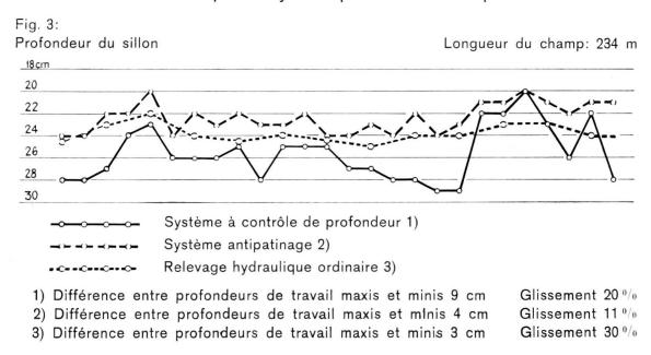
Le graphique reproduit ci-dessus se rapporte à un labour effectué sur un terrain à relief constamment inégal. Lors de l'emploi du **dispositif antipatinage**, l'amplitude d'oscillation de la profondeur de travail ne dépasse que de peu celle enregistrée avec la charrue portée ordinaire comportant une roulette d'appui. Si le glissement se montre beaucoup moins important, par contre, il faut dire aussi que la profondeur de travail est alors plus faible.
