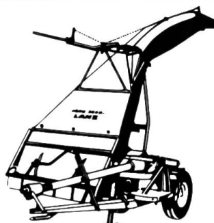
Récolteuse de fourrages à fléaux FL 110 et FL 140 pour une coupe et un ramassage de la récolte très propres. Largeurs de travail: 100 et 140 cm
