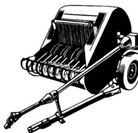
Presse ramasseuse F 80 et F 81 pour le pressage et le chargement du foin et de la paille. Largeur de ramassage 1,40 m. Rendement horaire 4 à 8 tonnes. Livrabable avec élévateur pour le fourrage vert.
