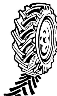
Fig. 2: Type de pneu à profil accrocheur (barrettes de traction) prévu pour les roues motrices de véhicules agricoles.
