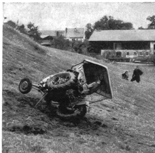
Fig. 3: Tracteur également muni d'un toit-abri de sécurité. On remarquera le mannequin de paille fixé sur le siège du conducteur. Malgré que cette machine ait fait 3 tours \frac{1}{2} sur elle-même, le toit-abri et le mannequin n'ont été nullement endommagés.
