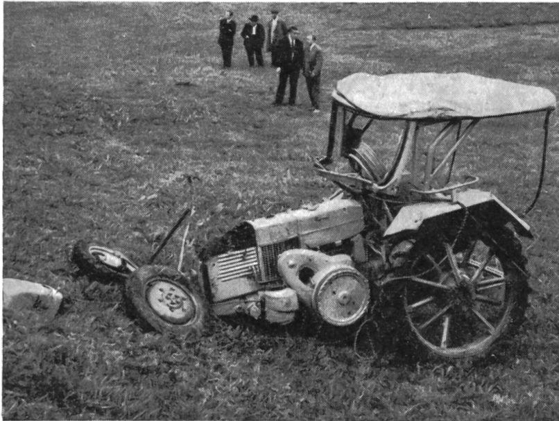
Fig. 4: Tracteur équipé d'un toit-abri de sécurité complété par un étrier de protection (encadrement de pare-brise renforcé). Voici l'état dans lequel la machine se trouvait après avoir roulé plusieurs fois sur elle-même (terrain de 80% d'inclinaison). Le toit-abri n'a subi aucun dégât. Par contre l'essieu avant et le bloc - moteur se sont rompus et détachés.
