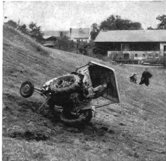
Fig. 3: Tracteur également muni d'un toit-abri de sécurité. On remarquera le mannequin de paille fixé sur le siège du conducteur. Malgré que cette machine ait fait 3 tours \frac{1}{2} sur elle-même, le toit-abri et le mannequin n'ont été nullement endommagés.
