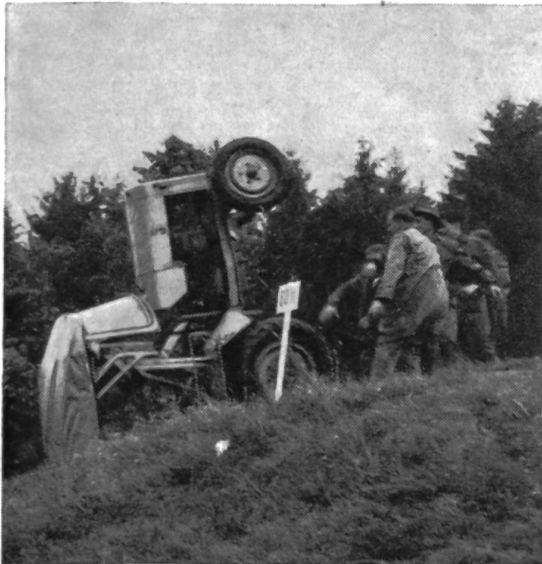
Fig. 2: Tracteur dont on a provoqué le cabrage. On peut voir d'après cette photo que le toit-abri de sécurité a empêché la machine de faire plus d'un quart de tour sur elle-même.
