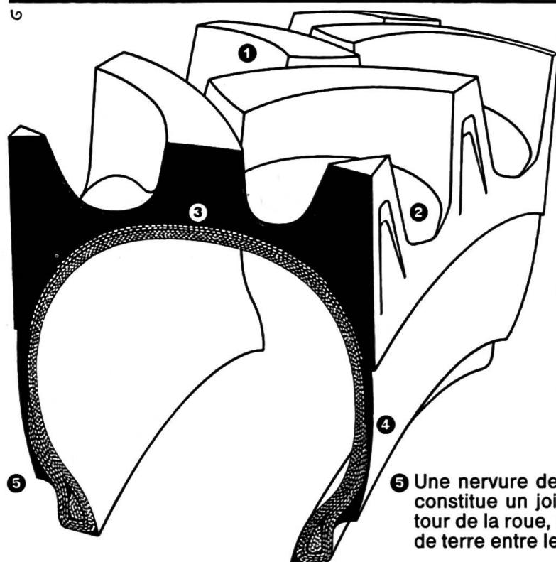
1 Les robustes nervures équilibrées du profil et le mélange amélioré du caoutchouc assurent un rendement optimum et une usure régulière en exploitation mixte.
