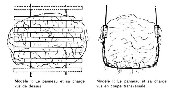
Fig. 2: Panneau souple à claire-voie à planches (6 à 8) placées transversalement par rapport à la direction d'avancement de la remorque et à câbles de levage disposés longitudinalement. Ici, le fourrage est entouré et retenu devant et derrière.
