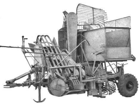
Vaste trémie pouvant contenir jusqu'à  $17^{1/2}$  quintaux de betteraves. Hauteur de déchargement: 2 m 60, ce qui permet de charger de façon régulière n'importe quel véhicule de transport agricole.
