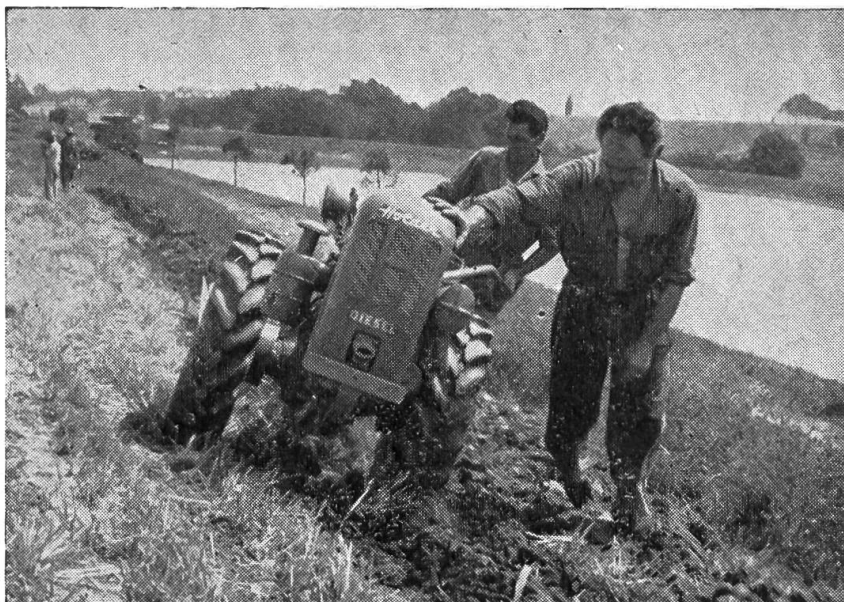
Fig. 4: Comme on peut s'en rendre compte par la photo ci-contre, l'emploi du tracteur à 1 essieu pour effectuer les labours sur les terrains inclinés devient très vite pénible, et tout particulièrement en bout de champ, lorsqu'il s'agit de virer la machine.
