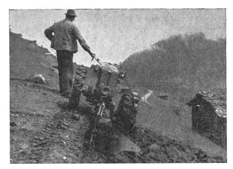
Fig. 14: L'agriculteur représenté sur cette photo est en train de mesurer le taux d'inclinaison de la pente pour savoir s'il peut continuer à labourer suivant le sens des courbes de niveau. Lorsque les labours sont effectués d'après cette technique de travail, la limite d'emploi du tracteur à 1 essieu se situe autour de 45% de déclivité.
