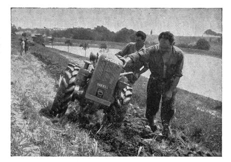
Fig. 5: Dans de vastes régions, les terrains de culture sont aménagés en terrasses sur des pentes accusant jusqu'à 45% de déclivité. Ces terrains se présentent toujours sous la forme de bandes disposées parallèlement aux courbes de niveau, ce qui rend l'utilisation du treuil très difficile. Du fait de cette disposition caractéristique des parcelles et de leur forte déclivité, les labours doivent être obligatoirement exécutés selon le sens des courbes de niveau et en versant vers le bas.
