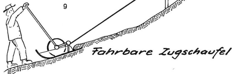
Fig. 9: Cette pelle à câble, du type ravale, est beaucoup employée dans le Tyrol. Elle permet de supprimer pratiquement tout travail manuel pour la remontée de la terre du bord inférieur de la parcelle au bord supérieur. Ce système exige toutefois de solides ancrages pour les poulies de renvoi et le treuil. Etant donné l'importance des efforts de traction auxquels le câble se trouve soumis au moment de la pénétration du tranchant de la pelle dans le sol, il se tend fortement. La prudence s'impose donc dans le voisinage d'une ligne électrique!
