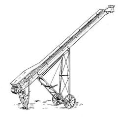
Le déchargement automatique des véhicules de récolte sur le tablier d'un élévateur mécanique mobile se heurte à quelques difficultés. Aussi aménage-t-on souvent une petite fosse pour y placer la partie inférieure de l'élévateur. Une trémie d'alimentation de grandes dimensions, dont la largeur correspond à celle du chargement, est alors adaptée sur l'élévateur. L'inconvénient présenté par le système en question est que l'on se trouve
