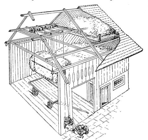
Les monte-charge soulèvent tout le chargement du véhicule de récolte d'un seul coup. Des perches et des chaînes sont posées respectivement longitudinalement et transversalement sur le pont du char avant de charger le fourrage. Pour décharger, on pend les chaînes aux crochets des câbles du monte-charge. Ce système permet de rentrer trois chargements avec un seul véhicule sans qu'il soit nécessaire de déverser et de répartir tout de suite le foin sur le tas.
