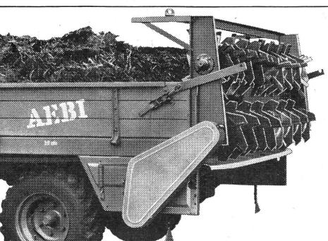
Livrable dans les exécutions suivantes: Appareils épandeurs horizontaux et verticaux (démontables sans outils; transformation rapide en remorque polyvalente)/Modèles à 1 et à 2 essieux pour des charges utiles de 2—4 tonnes/Bac à céréales à bascule hydraulique pour transports en vrac/Nous livrons aussi les chargeuses à fumier hydrauliques ATLAS
