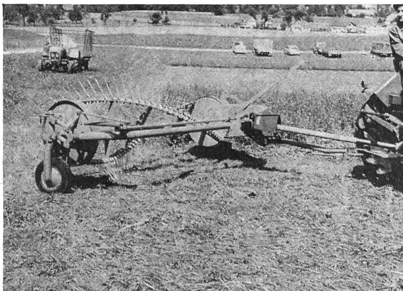
Fig. 1: Aspect de l'épandeuse-faneuse, machine de fanage permettant d'épandre et de fanner le fourrage, ainsi que de disperser les andains. Largeur de travail: 2 m 50, prix: fr. 1350.—
