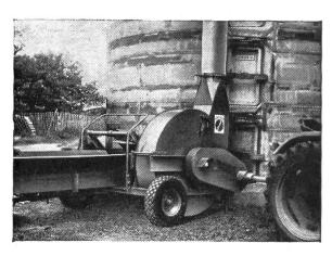
Elévateur pneumatique «Speiser-Presto» à grand débit prévu pour être actionné par la prise de force des tracteurs.
