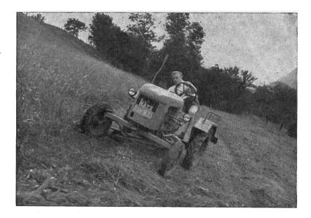
Rappelons à ce propos que lorsqu'un corps repose sur un plan, il faut, pour qu'il soit en équilibre, que la verticale menée par le centre de gravité tombe à l'intérieur de la base de sustentation (d'appui). Pour qu'un tracteur soit stable, sa base de sustentation doit donc être assez grande (grand écartement des roues) et il faut que son centre de gravité soit aussi bas que possible.
