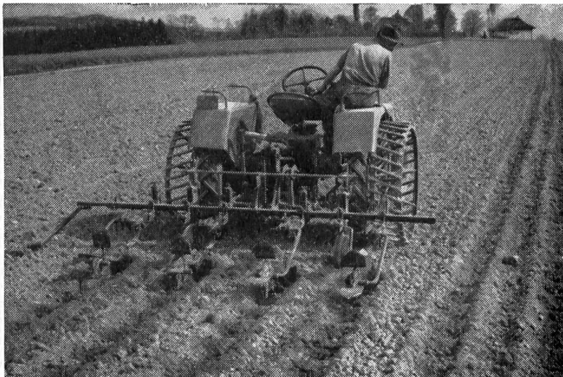
Fig. 5: Creusage des trous de plantation sur trois rangs au moyen de marqueuses à pelles (roues motrices pourvues de roues d'adhérence à barreaux).
