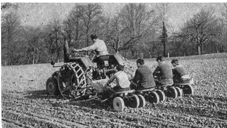
Fig. 11: Tracteur équipé de roues- cages et tirant une batterie de quatre plan- teuses de pommes de terre semi-automatiques.
