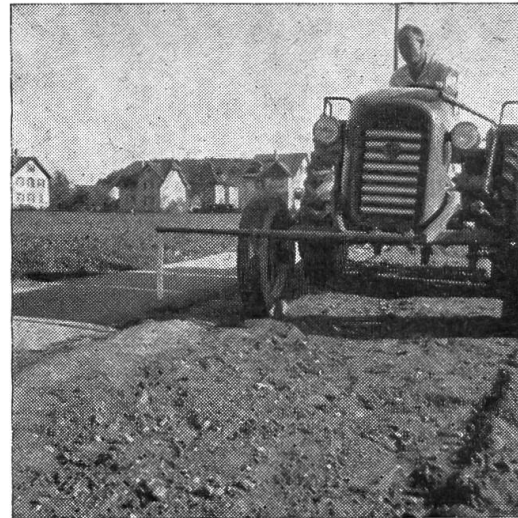
Fig. 3b: Dispositif de guidage frontal permettant d'avancer en ligne droite au début du travail de plantation (premier passage).
