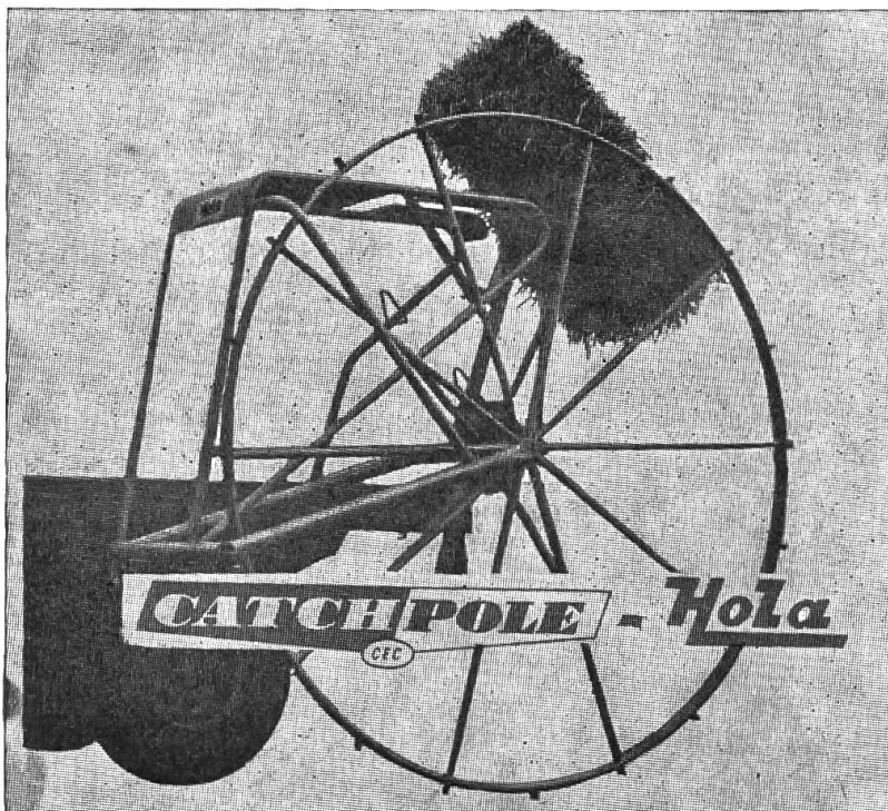
Fig. 10: Grâce au chargeur Catch- pole, le ramassage des balles disposées en ran- gées se trouve grande- ment facilité.
