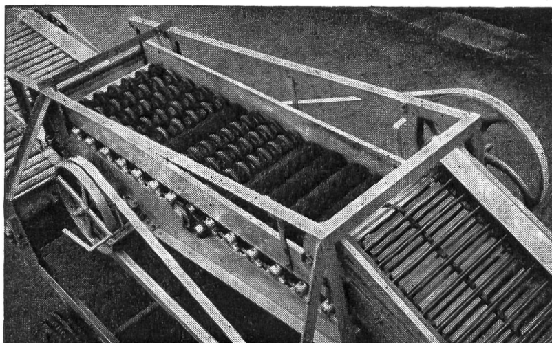
Fig. 13: Trieur-calibreur à pommes de terre de conception nouvelle dont les organes de calibrage sont constitués par des rouleaux en caoutchouc.
