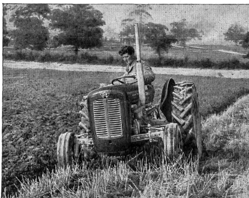
Fig. 14: Depuis un certain temps, les tracteurs Massey-Ferguson sont tous pourvus d'un différentiel à système de verrouillage. Sur demande, ils peuvent être aussi livrés avec un réducteur à enclenchement hydraulique.
