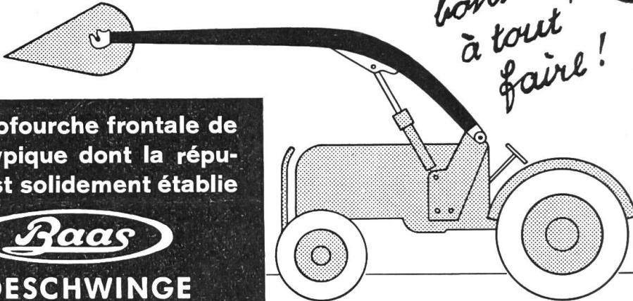
Le chargeur frontal Baas, qui a fait ses preuves depuis plus de 13 ans, exécuté tous les travaux de chargement et de transport qui se présentent dans une exploitation agricole. Les chargeurs frontaux Baas peuvent être montés sur n'importe quel tracteur de marque suisse et sur de nombreux tracteurs de provenance étrangère. Ils sont fabriqués en plusieurs exécutions normalisées, qui ont été adaptées aux puissances et types de construction des différents tracteurs.
