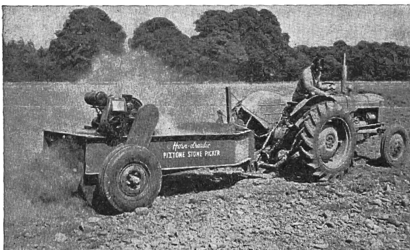
Fig. 1: Aspect de l'épierreur «Pix Tone». Le tambour à dents, mû par un moteur auxiliaire, assure le char- gement des pierres re- cueillies dans la corbeille métallique semi-cir- culaire.
