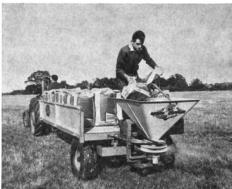
Fig. 4: Autre type de distribu- teur d'engrais centrifuge en matière plastique. L'entraînement du disque épandeur a lieu ici hy- drauliquement, par l'intermédiaire de la pompe du tracteur.
