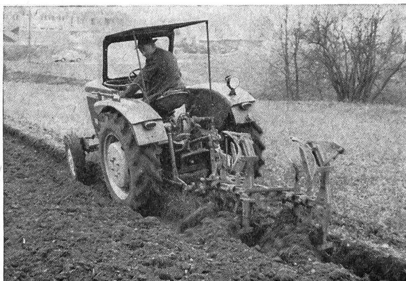
Fig. 1: Un tracteur équipé d'un bloc hydraulique de type moderne, à dispositif automatique de régulation constante de la profondeur de travail et système de transfert de charge, arrive à labourer 25 à 35 ares par heure, suivant les conditions de travail, avec une charrue à 2 socs.
