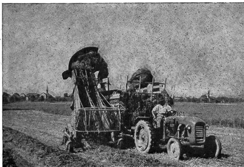
Fig. 1: Reprise d'andains de fourrage préfané avec une ramasseuse-chargeuse attelée en parallèle (couloir de chargement incurvé).
