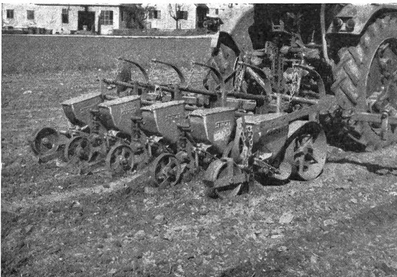
Fig. 10: Semoir monograine S (à courroies de caout- chouc tournant en sens contraire) fixé sur la barre porte-outils d'un instrument universel.
