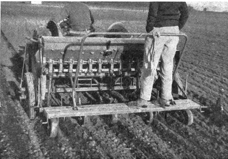
Fig. 9: Semoir HLS (à canne- lures, déversoirs à encoche).
