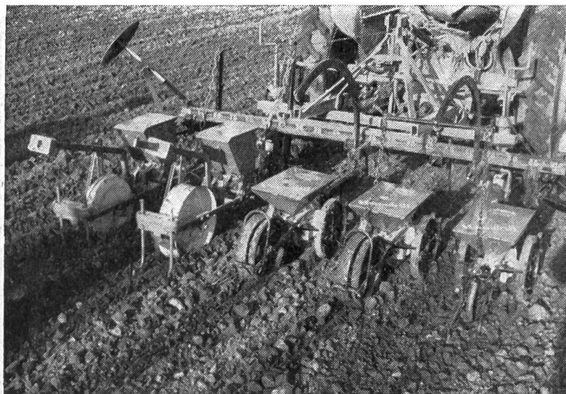
Fig. 11: Instrument universel Bucher équipé: à gauche, de 2 semoirs monograins E; à droite, de 3 semoirs monograins M.
