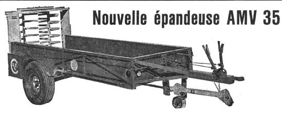
charge: 3,5 m³, largeur d'épandage: 5 à 6 m., 6 vitesses d'avancement du tapis, réglables depuis le siège du tracteur. Carters entièrement à bain d'huile, avec sécurité de déclenchement en cas de corps étranger. Pneus 900 x 13 AW Farmer. Transformable en: remorque de transport avec pont 4 m. x 1,7 m., char pour ramasseuse-hacheuse-chargeuse avec déchargement automatique, remorque à bétail, etc. Fabriquée en grande série entièrement dans notre usine. Garantie une année.
