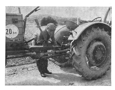
Fig. 11: Contrôle de la longueur correcte des parties coulissantes de l'arbre à joints de cardan (ici elles sont trop longues).
