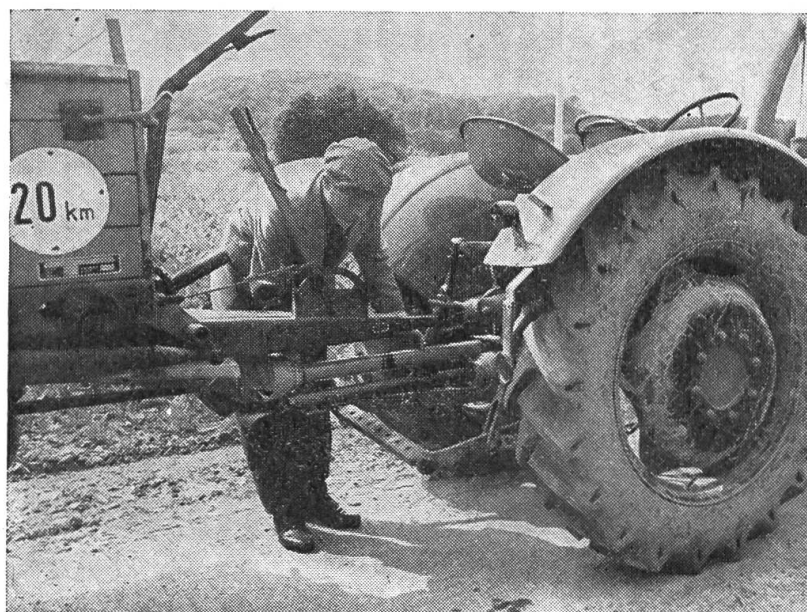
Fig. 11: Contrôle de la longueur correcte des parties cou- lissantes de l'arbre à joints de cardan (ici elles sont trop longues).
