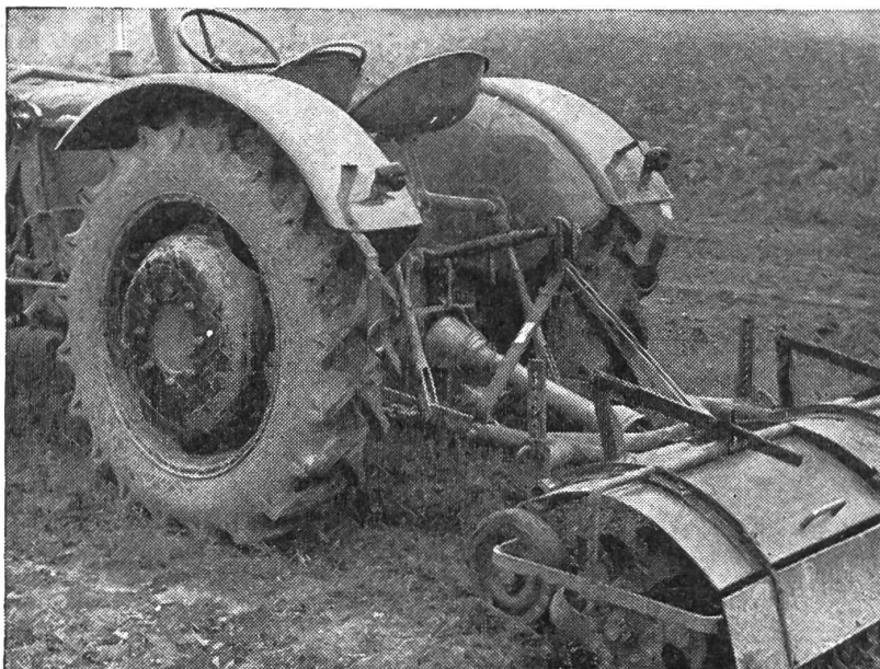
Fig. 12: Herse rotative commandée, correctement accouplée (les angles de déviation faits par les deux joints de cardan sont corrects et égaux).
