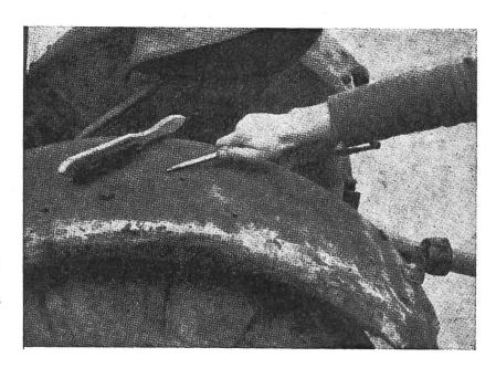
Le racloir et la brosse métallique sont les deux principaux outils à utiliser pour le dérouillage
