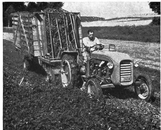
La remorque autochargeuse chargeant du fourrage vert. Le travail (fauchage, ramassage et chargement par paquets) est effectué par un seul homme et en un seul passage.
