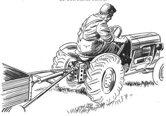
Le dispositif de commande hydromécanique «Tétrax 303», qui permet de rouler avec sécurité, s'adapte à n'importe quel frein de remorque. Celle-ci peut être freinée efficacement et sans peine depuis le siège du tracteur.
