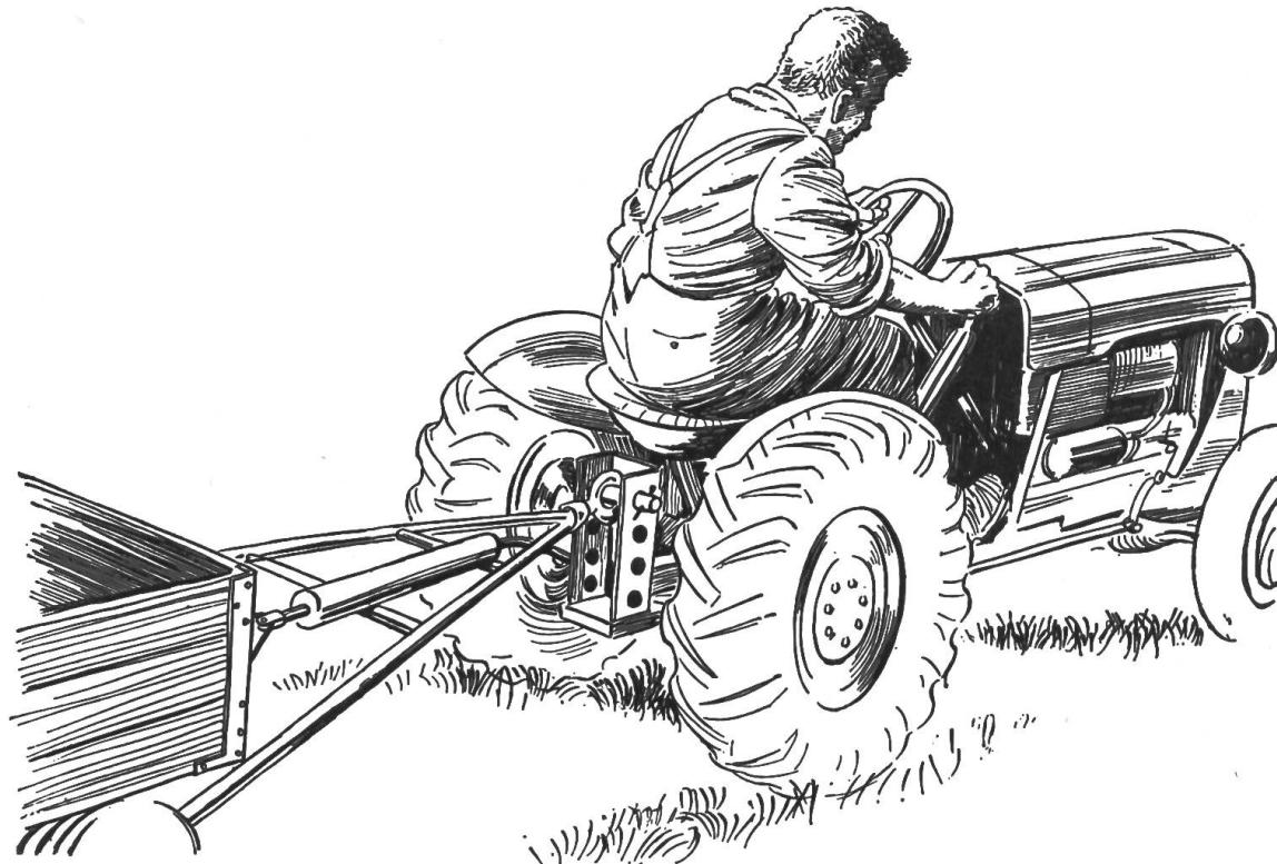
Le dispositif de commande hydromécanique «Tétrax 303», qui permet de rouler avec sécurité, s'adapte à n'importe quel frein de remorque. Celle-ci peut être freinée efficacement et sans peine depuis le siège du tracteur.
