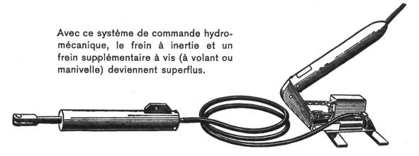
Le dispositif de commande en question pour freins de remorques, appelé «Tétrax 303», se compose essentiellement de trois parties distinctes, soit d'un organe de commande à manette, d'un maître-cylindre à
