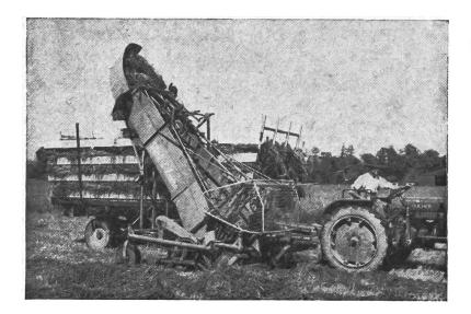
Fig. 1: La machine Mörtl-Zentro ramasseuse-chargeuse à barres entraîneuses, est attelée en parallèle.
