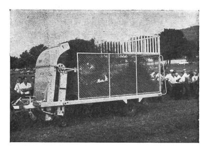
Fig. 10: Prototype du véhicule autochargeur suisse Agrar-Tempo.
