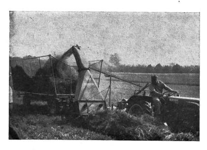
Fig. 3: Récolteuse de fourrages à fléaux ramassant et chargeant pneumatiquement un gros andain de foin de trèfle.
