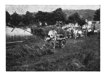
Fig. 6: Laminage et épandage du fourrage en une seule opération à l'aide du conditionneur IHC.
