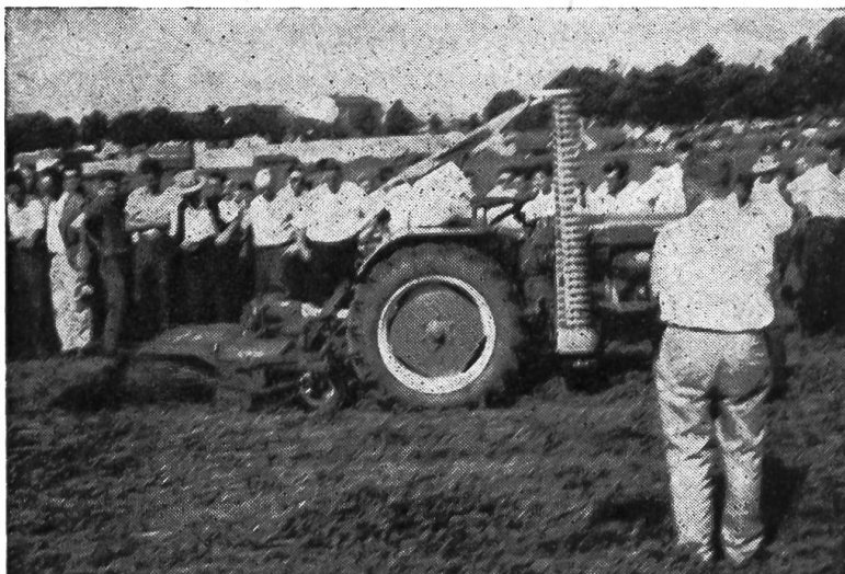
Fig. 6: Laminage et épandage du fourrage en une seule opération à l'aide du conditionneur IHC.
