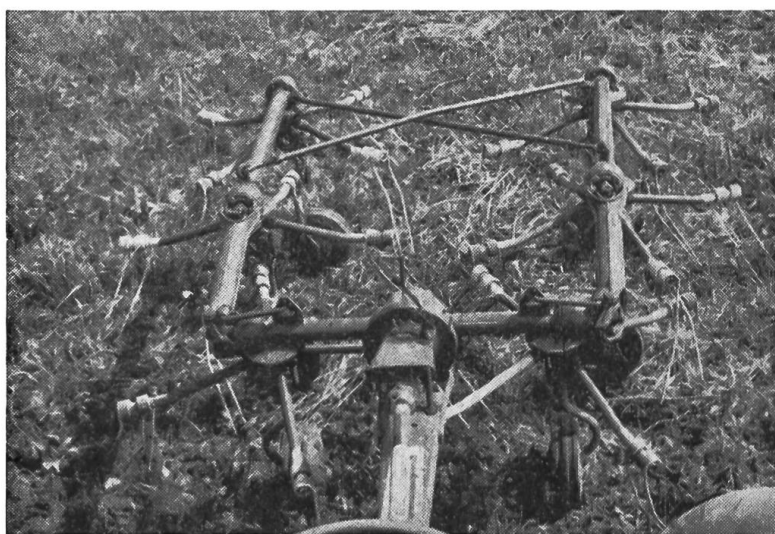
Fig. 9: Le même faneur mis en position de transport. On distingue nettement ses six éléments à quatre bras dont chacun com- porte une tête de fourche à deux dents.
