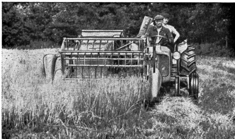
Fig. 11: Petite moissonneuse- batteuse de conception nouvelle prévue pour être attelée sur le côté du tracteur.
