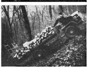
Fauchage-épandage en une opération – avec Aucune pente n'est trop rapide avec la traction par câble et 4 roues motrices
