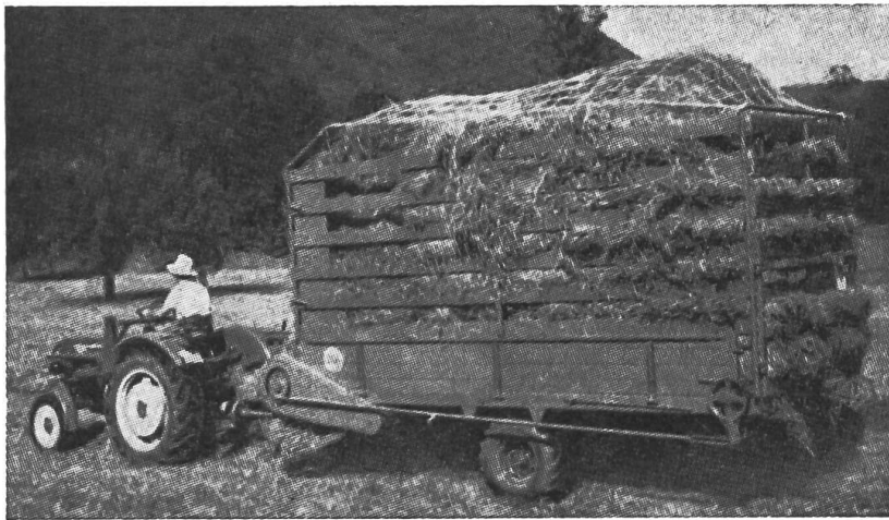
Fig. 4: Véhicule de récolte de conception nouvelle qui se remplit par le bas. — Ce système paraît présenter un intérêt particulier pour le ramassage des fourrages secs, car il permet d'obtenir une certaine compression du foin.
