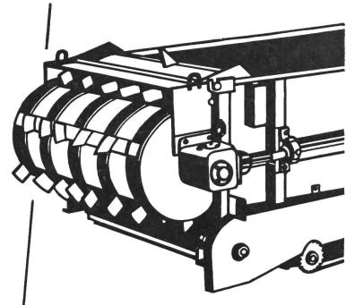
Le tambour-distributeur est comparativement le coeur de chaque épandeuse à fumier. Il décide de la finesse de distribution et d'un travail parfait avec n'importe quel genre de fumier (pailleux ou vieux). L'épandeuse à fumier AGRAR possède un seul tambour qui tourne à environ 800 t/min. Il permet d'obtenir un épandage très fin et régulier. La quantité du fumier à épandre est facilement réglable depuis le siège du tracteur.
