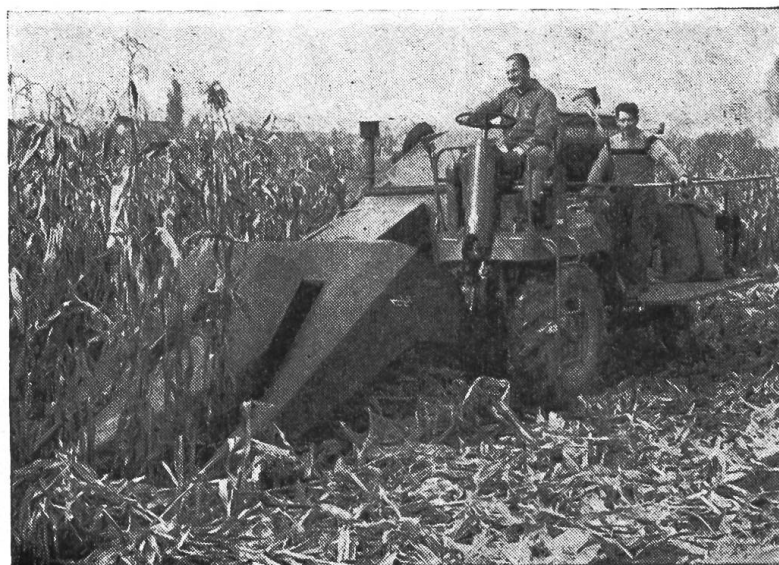
Fig. 10: Moissonneuse-batteuse comportant une récolteuse d'épis de maïs en lieu et place de la barre de coupe.
