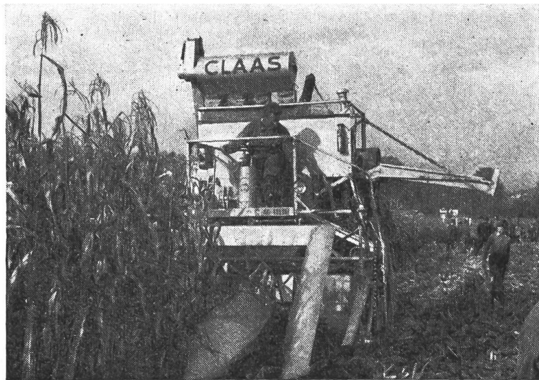
Fig. 8: Moissonneuse-batteuse adaptée pour la récolte de la plante entière (montage de becs guides sur la barre de coupe).
