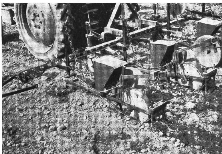
Fig. 2: Batterie de semoirs mono- graine — Les grains sont semés à l'aide de pla- teaux inclinés à alvéoles.
