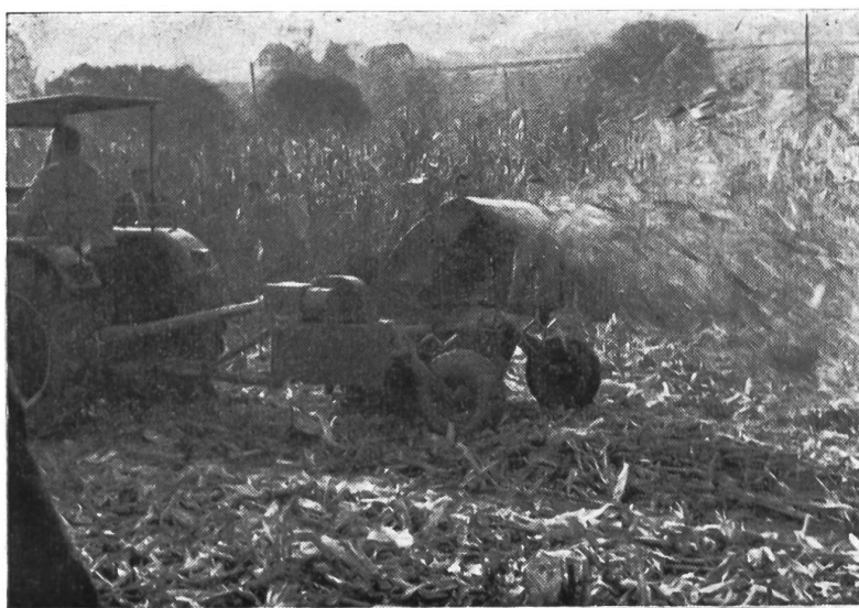
Récolteuse à fléaux utilisée pour émietter les tiges sèches du maïs-grain.
