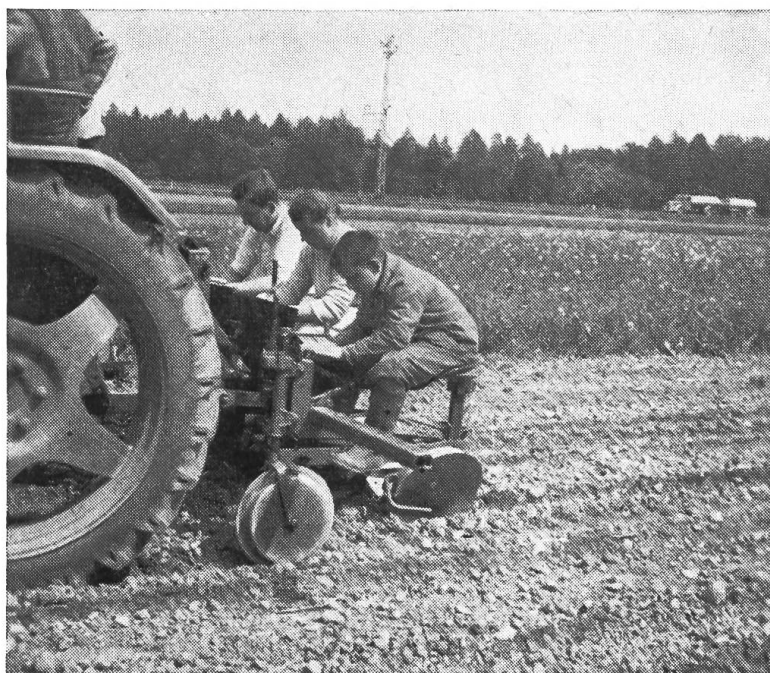
Fig. 1: Emblavage du maïs avec une batterie de planteuses monorang semi-auto- matiques.
