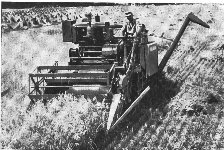
Fig. 8 La moissonneuse-batteuse munie dans réservoir à grains permet de travailler avec une seule personne.
