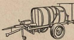
Remorque BIMOTO - ARBOR - Tracteur. Châssis ARBOR-Tracteur, 1000 litres, pneus 9.00 x 13''. Groupe BIMOTO - Titan à haute pression 75/60. Soupape de décharge automatique. Barre de traitement verticale pour l'arboriculture. - Grand filtre d'aspiration avec robinet d'arrêt.
