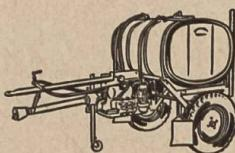
Remorque BIMOTO - Tracteur. Châssis Tracteur, 600 litres, pneus 6.00 x 16''. Groupe BIMOTO-Zénith à haute pression 50/60. Soupape de décharge automatique. Barre de sulfatage pour 11 lignes avec jets. Fanjet-Saphir à éventail. Grand filtre d'aspiration avec robinet d'arrêt.
