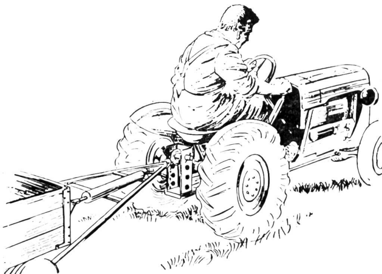
Fig. 13: Type de frein hydromécanique pouvant être actionné sans peine par le conducteur de tracteur depuis son siège.
