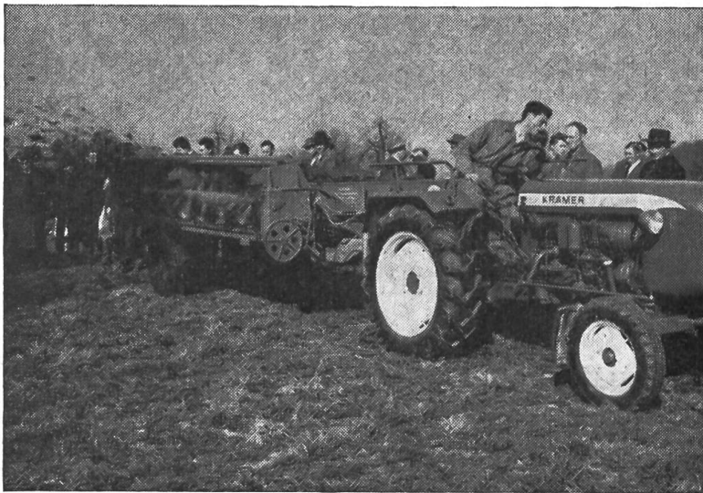
Fig. 4: Épandeuse de fumier à distribution latérale — On remarquera que c'est la partie arrière du charge- ment qui est épandue ici. Dès que ce compartiment sera vide, il suffira de manœuvrer un levier pour que ce soit au tour de la partie avant d'être émiettée et distribuée.
