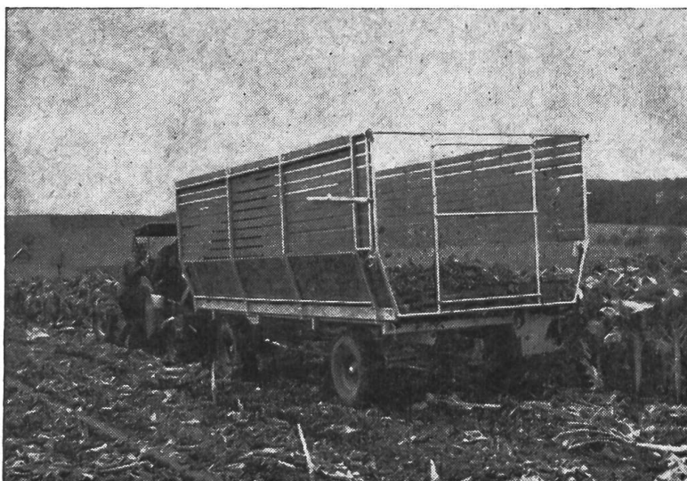
Fig. 6: Epandeur à deux essieux convertie en char à cadres pour produits hachés.
