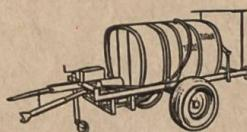
Remorque BIMOTO - ARBOR - Tracteur. Châssis ARBOR-Tracteur, 1000 litres, pneus 9.00 x 13". Groupe BIMOTO - Titan à haute pression 75/60. Soupape de décharge automatique. Barre de traitement verticale pour l'arboriculture. - Grand filtre d'aspiration avec robinet d'arrêt.
