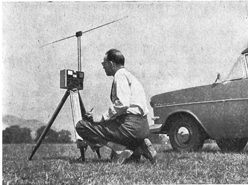
Fig. 3: Contrôle de l'efficacité du déparasitage du moteur d'une voiture automobile à l'aide d'un indicateur d'intensité de champ.
