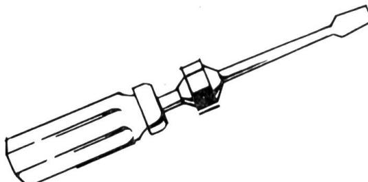
Pour obtenir plus de puissance d'un tournevis sans endommager le manche, EDWIN TINGLEY, de RIVERSIDE, N. B., a soudé à la tige un écrou hexagonal.
