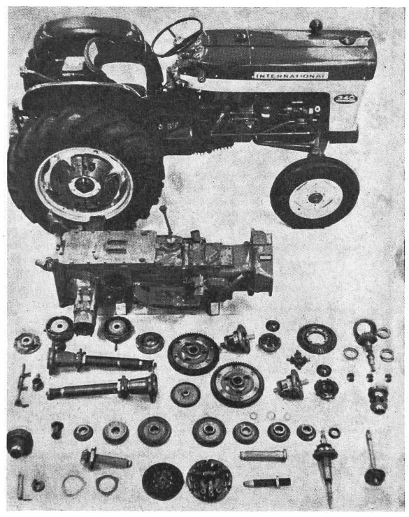
Le système de transmission hydraulique dont est actuellement équipé le nouveau tracteur réalisé par l'International Harvester Company (IHC) en tant que prototype a été aussi monté sur un modèle normal comportant un moteur de 40 ch à pistons. La photo ci-dessus représente le tracteur «Utility 340», à côté duquel ont été disposés tous les organes et pièces que l'adoption de la transmission hydraulique a permis d'éliminer.
