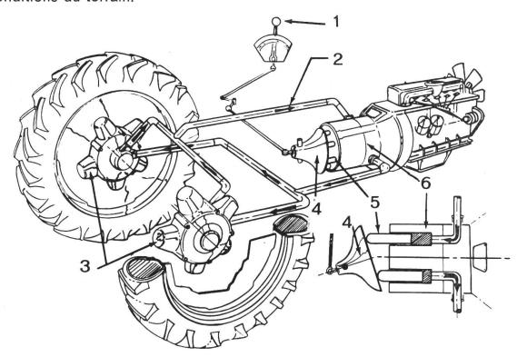
Schéma du système de transmission hydrostatique mis au point dans les laboratoires de l'International Harvester Company (IHC), aux Etats-Unis. Ce système comporte trois éléments essentiels: une pompe actionnée par le moteur et deux moteurs radiaux incorporés aux roues arrière.
