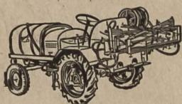
**BIMOTRA S-V** Châssis autotracté, 600 litres, avec moteur à essence VW ou Diesel MWM
