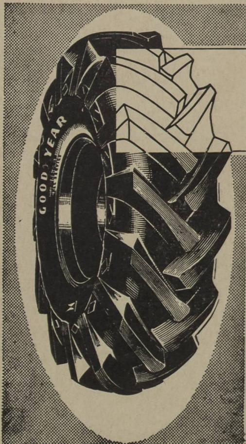
Bande de roulement à fortes nervures « antipatinage » s'élargissant vers le centre du pneu. La partie centrale — la plus large — est étudiée pour la route. La partie extérieure — la plus étroite — est conçue pour les champs.
