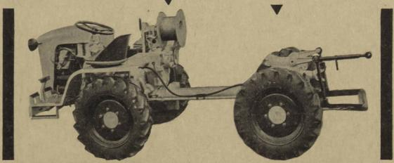
Possibilité d'accoupler tous instruments (barre faucheuse, herse rotative commandée, pulvérisateur arboricole, etc.). Avec long empattement et plateau de charge, constitue un véhicule tous-terrains aux performances extraordinaires.
