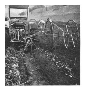
Arracheuse à fourches rotatives avec tablier d'arrêt et corbeille réceptice
