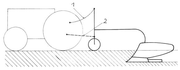
Fig. 9: 1 = Chaîne fixée en lieu et place de la bielle supérieure 2 = Bielles inférieures de l'attelage trois-points
