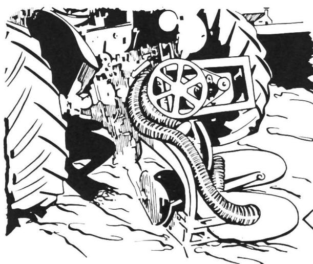
Ces croquis permettent de se faire une idée suffisamment précise du principe de fonctionnement de la charrue à versoirs «lubrifiés» par air. Au-dessus des versoirs se trouve un réservoir à air comprimé alimenté par un compresseur qu'en- traîne le moteur du tracteur. Les versoirs, qui comportent de nombreuses perforations, sont reliés au réservoir par de grosses conduites souples.
